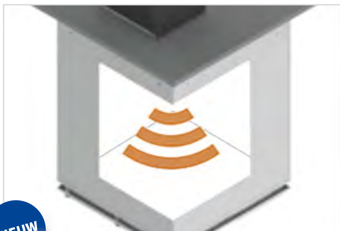
Hoogtemeting dmv ultrasoonsensoren
